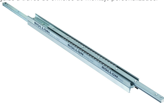
Figura 3. Las guías lineales de la serie DE de Rollon en tamaños de bastidor de 35 mm se utilizan en subconjuntos de control de retracción en equipos de fabricación de dispositivos médicos. Las pistas de rodadura de las guías están recubiertas de níquel duro para resistir los procedimientos de lavado estándar.
