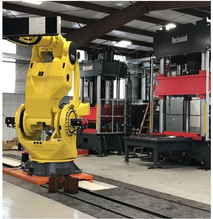
Figura 2. Esta RTU de acero de Rollon sostiene al FANUC M2000 en una instalación en subsuelo, portátil.
