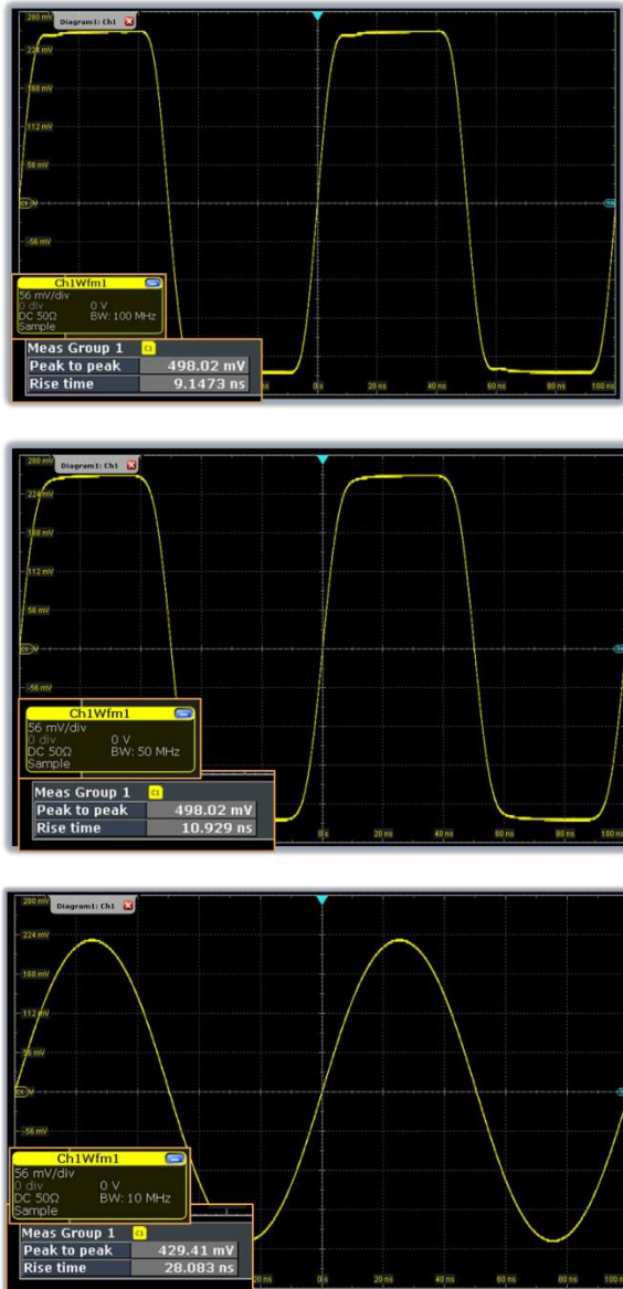
Figura 5: De arriba a abajo, medir la misma onda cuadrada de 10 MHz con anchos de banda más estrechos produce resultados cada vez más inexactos en términos de forma y amplitud de onda (consulte los valores numéricos en cada recuadro inferior izquierdo).
