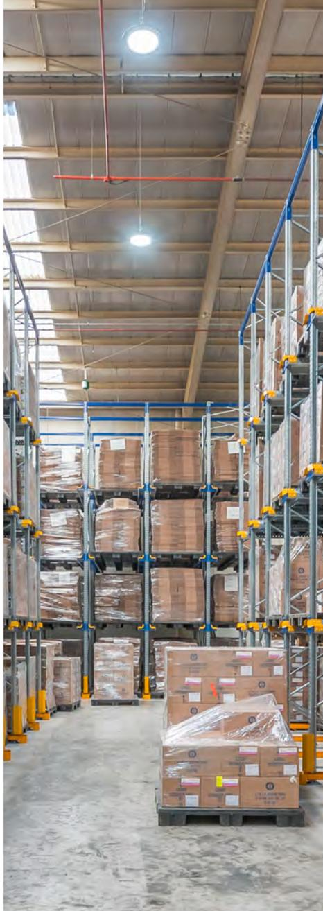
son lo suficientemente anchas para permitir el ingreso de los montacargas. Su diseño permite un ingreso en ambos extremos del bloque, siendo ideal para cargas que no soportan el apilamiento libre.
