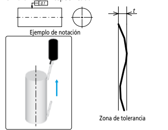
Ejemplo de verificación utilizando un aparato de medición de forma
