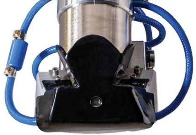
La tecnología única de los sistemas de Nikon de intercambiar 5 cabezas de objetivo en la misma base del tubo de rayos X permite la mejor calidad de imagen en el mercado mundial, sin la necesidad de usar una configuración de doble tubo.
