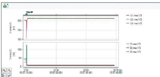
Ejemplo de pantalla de caída de tensión (datos de fluctuación de eventos de 30 segundos)
