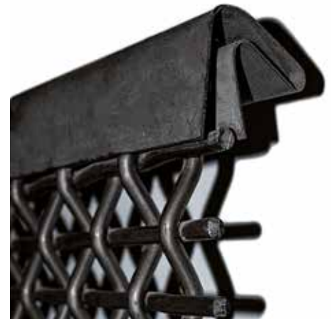
Criba: Acero negro 1018. Tejido: sencillo. Sistema de sujeción: doblez con lámina. Abertura: 5/16" X 5/16" Cal. 5/32.
