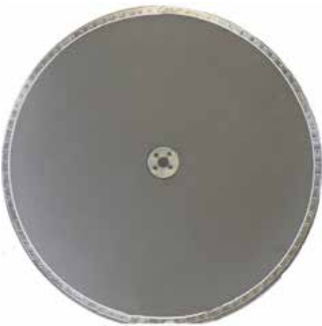
ARO PERFIL REMACHADO Aro para equipo cribador circular: 48" en acero inoxidable Mesh: 100 x 100. Sistema de sujeción: perfil remachado.
