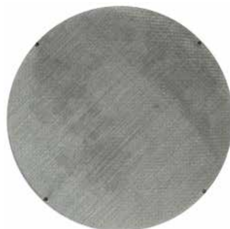
Pack de malla metálica: Acero inoxidable 316. Tejido: sencillo con malla de soporte 60 x 60 y malla fina 200 x 200 punteados.
