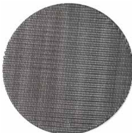
Disco de malla metálica: Acero inoxidable 316. Tejido: holandés con malla 24 x 110.
