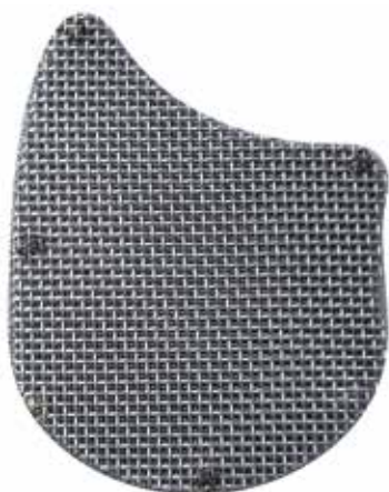
Pack de malla metálica: Acero inoxidable 316. Tejido: sencillo con malla de soporte 16 x 16 y malla fina 60 x 60 punteados.
