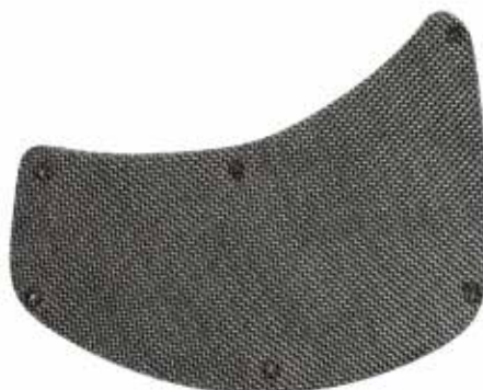
Pack de malla metálica: Acero inoxidable 304. Tejido: sencillo con malla de soporte 20 x 20 y malla fina 80 x 80 punteados.
