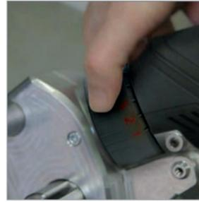
Tensión ajustable y resistente 10 ajustes de hasta 800 daN/1800 lbf.
